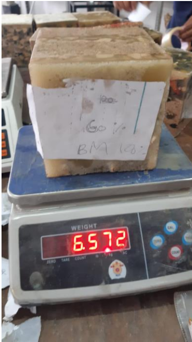
Dokumentasi pada tahap pengukuran berat pada benda uji BM60(1)
