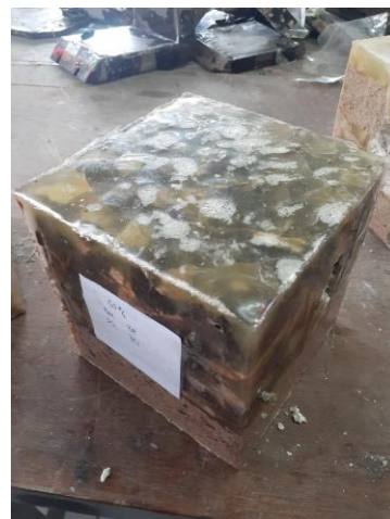
Dokumentasi sebelum dilakukan uji tekan pada benda uji BM60(2)
