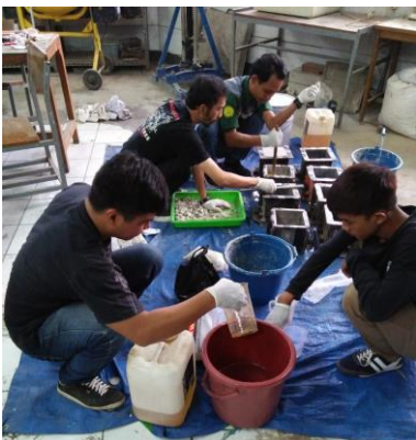
Dokumentasi pada tahap menyiapkan campuran Resin dan hardener
