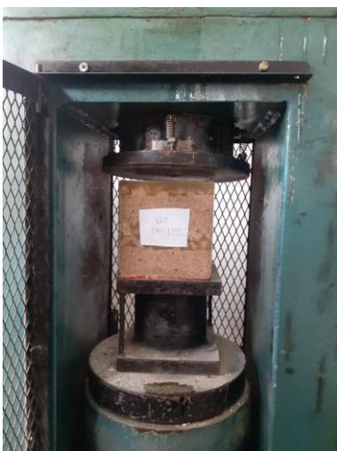
Dokumentasi Uji Tekan pada benda uji BM60(3)
