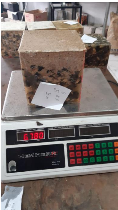
Dokumentasi pada tahap pengukuran berat pada benda uji BM60(3)
