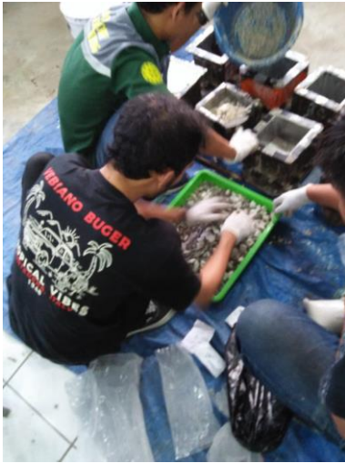
Dokumentasi pada tahap penyiapan campuran agregat kasar
