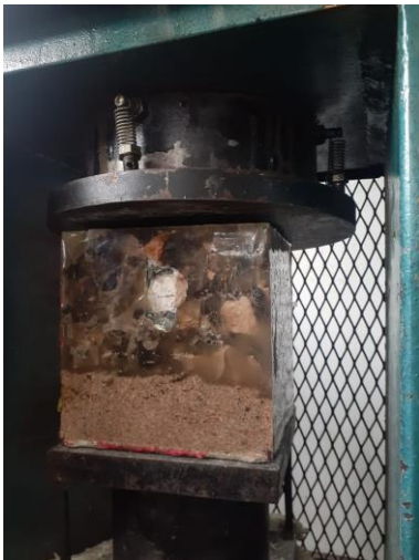
Dokumentasi Uji Tekan pada benda uji BM60(2)
