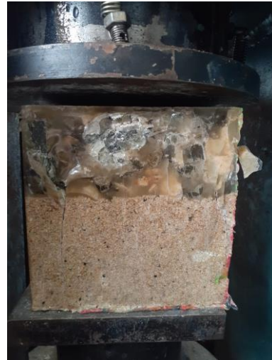
Dokumentasi Hasil Kehancuran setelah dilakukan Uji Tekan pada benda uji BM60(3)
