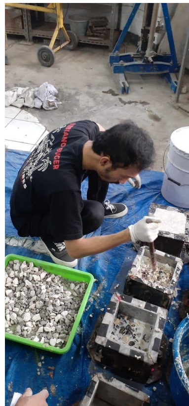
Dokumentasi pada tahap penyiapan campuran agregat kasar
