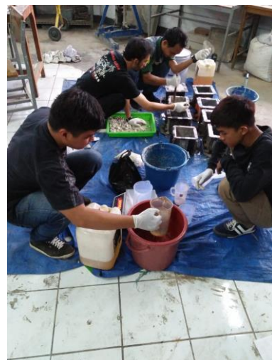
Dokumentasi pada tahap menyiapkan campuran Resin dan hardener
