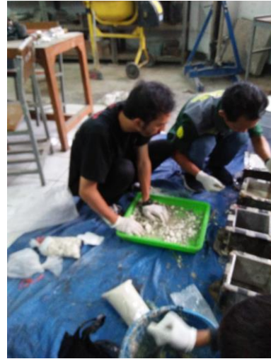
Dokumentasi pada tahap penyiapan campuran agregat kasar
