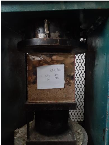
Dokumentasi Uji Tekan pada benda uji BM60(1)
