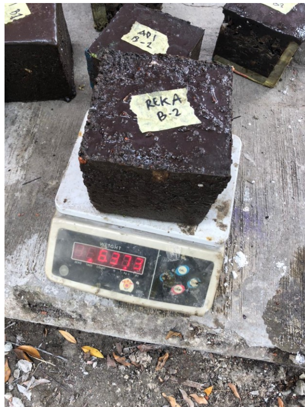
Gambar 4. 6 Benda Uji 2 Pasta Polimer 40%)
