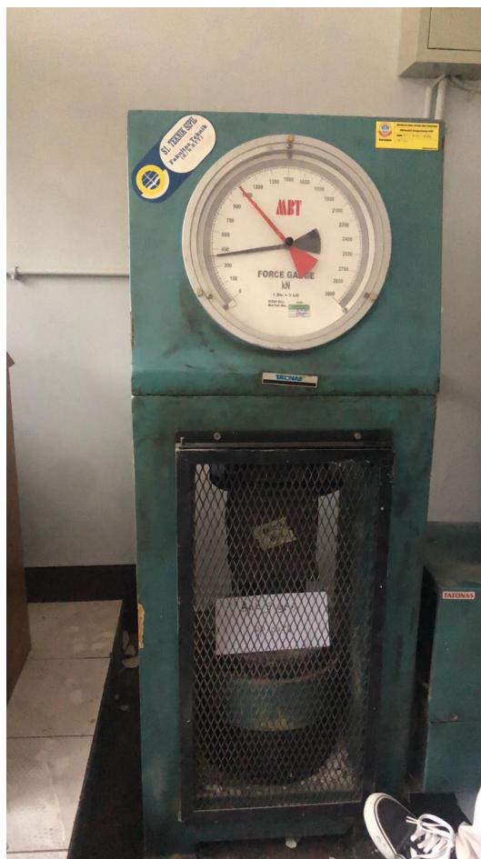
Gambar 4. 7 Pengujian Benda Uji 2 Pasta Polimer 40%
